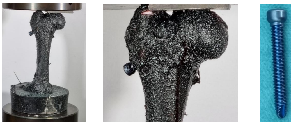
Slika 6. Učvršćivanje umetanjem titanskih vijaka u glavu bedrene kosti (izvor: autor).
