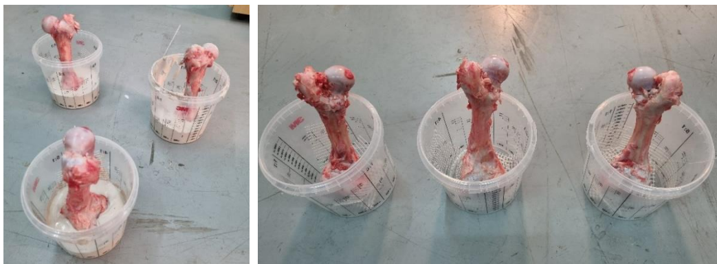
Slika 4. Donji dio bedrene kosti pozicioniran u gipsani kalup (izvor: autor).
