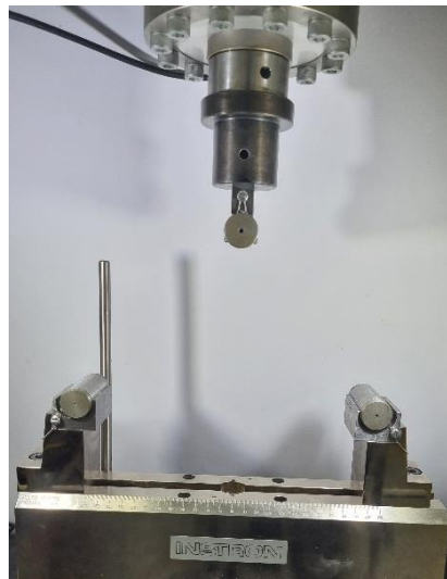
Slika 7. . Mehaničke stege za savijanje u tri točke na univerzalnom hidrauličkom ispitnom stroju "INSTRON 8800" s maksimalnom silom od 50 kN (izvor: autor).
