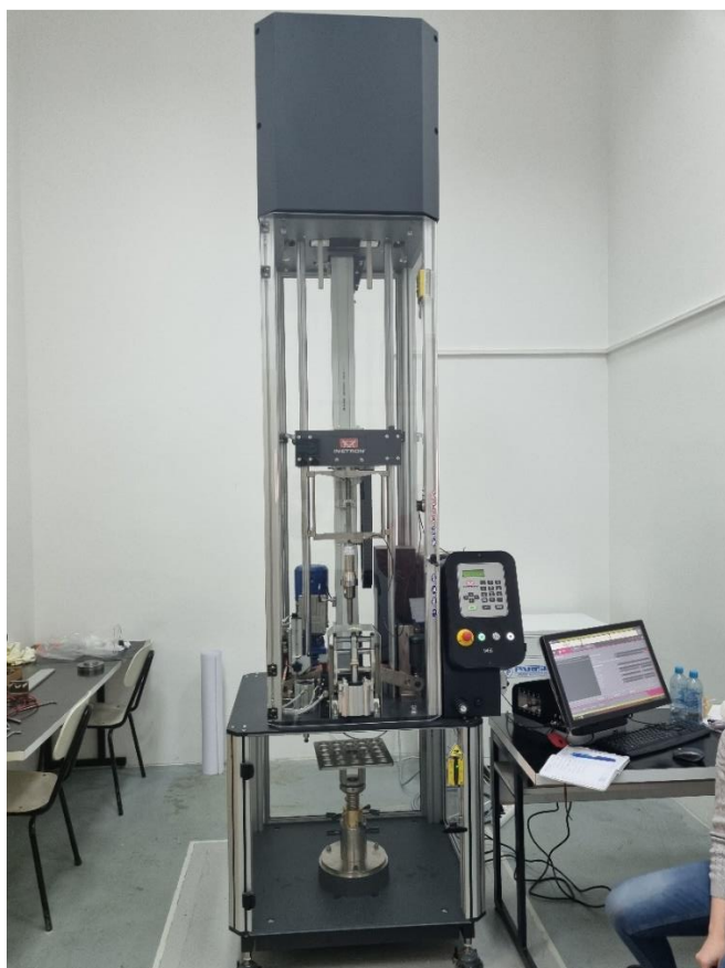
Slika 11. Instron Drop Tower 9450, laboratorij katedre za konstrukcije (izvor: autor).
